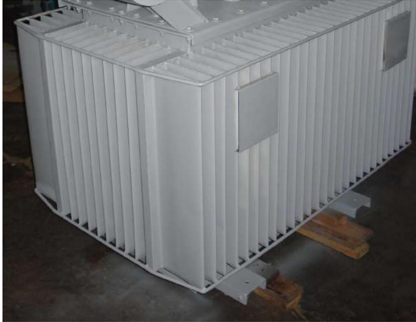
***Pintura en base epóxica de tanque de transformador 400kVA***
